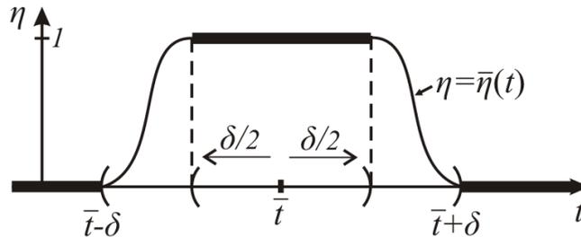
Рис. 1.4. Специальная пробная функция
